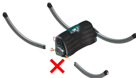
Felaktig montering (benen får INTE monteras först)
